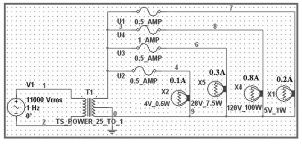
FIG. 7. SIMULATION CIRCUIT ON DISTRIBUTION STAGE
