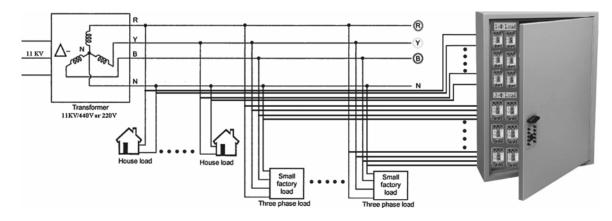
FIG. 9. THE PRACTICABLE LAYOUT ON THE DISTRIBUTION STAGE
