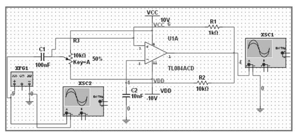
FIG. 2. SIMULATION CIRCUIT ON TRANSMISSION STAGE
