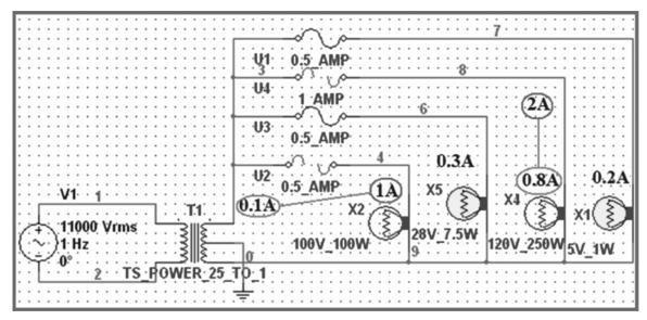
FIG. 8. SIMULATION RESULT OF CIRCUIT ON DISTRIBUTION STAGE
