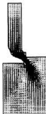
Sl. 7 – Strujno polje u y - z ravni, x = 2 cm, na 75^\circ\text{KV} posle SMT (zona usisnog ventila)
