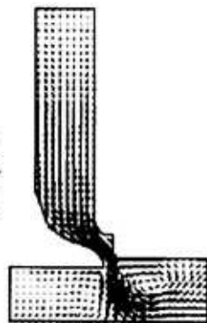
Sl. 4 – Strujno polje u y-z ravni, x = 2 cm, na 15^\circ\text{KV} posle SMT (zona usisnog ventila)
