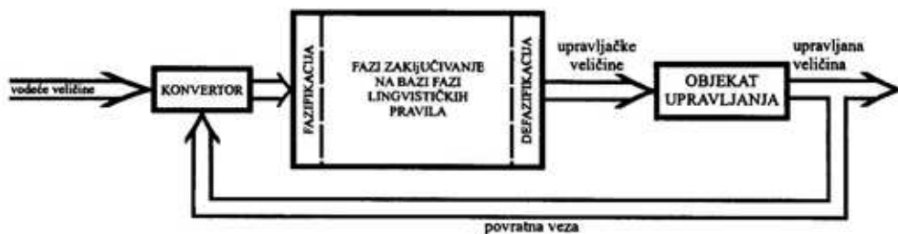
Sl. 1 – Opšta struktura fazi sistema automatskog upravljanja
