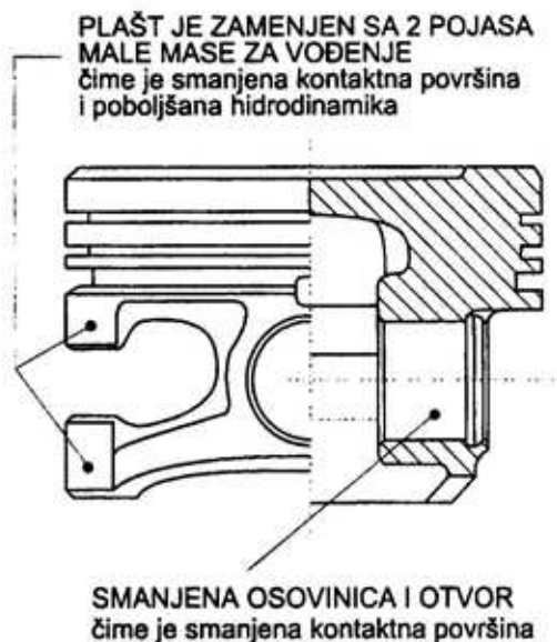
Sl. 5 – Klip sa smanjenom kontaktnom površinom plašta koja smanjuje trenje i masu klipa
