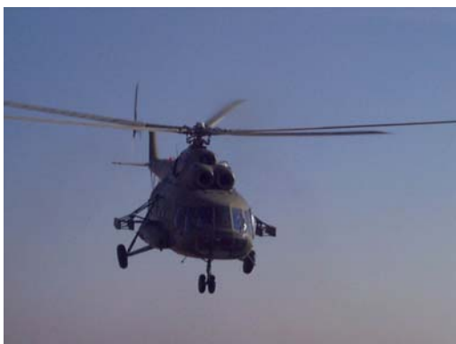
Sl. 1 – Transportni helikopter Mi-8: – masa: 11.100 kg; – broj LNR: 5; – broj obrta NR: 192 o/min (3,2 Hz); – DLNR ispuna: HEXEL; – konfiguracija: sa unutrašnjim teretom, sa spoljašnjim teretom
