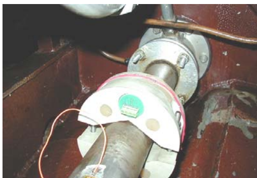
Sl. 2 – Napajanje mernog mosta i beskontaktni prenos signala
