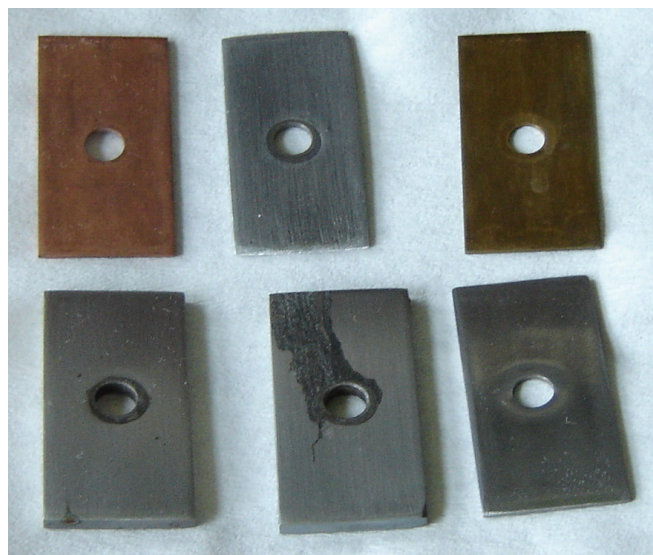
Sl. 9 – Izgled etalon-pločica koje su korodirale u tečnosti za hlađenje
