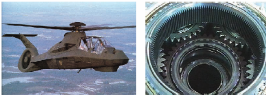
Slika 7 – Primena laserskog bombiranja visokoopterećenih prenosnika snage na helikopteru tipa „Comanche“ RAH 66
