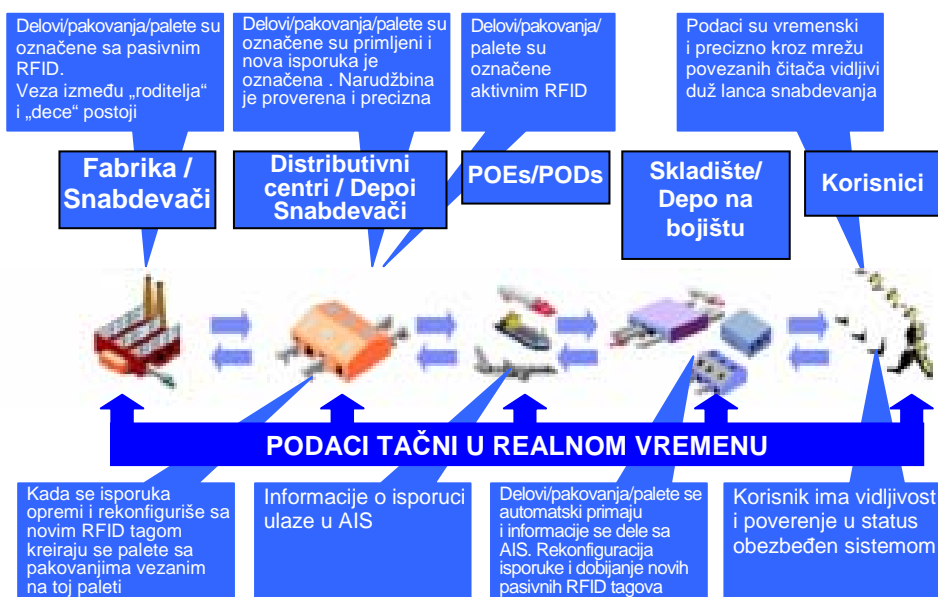
Slika 3 – Prikaz lanca snabdevanja koji koristi RFID tehnologiju Figure 3 – Display of a supply chain using RFID technology
