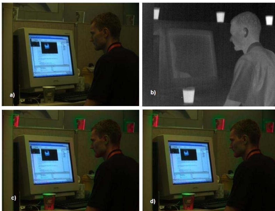
Slika 12 – Kolor sjedinjavanje slika na sekvenci u unutrašnjim uslovima: a) i b) ulazne TV i termovizijske slike, c) i d) rezultati sjedinjavanja koristeći laβ kolor sistem bez isticanja i sa isticanjem ivica
