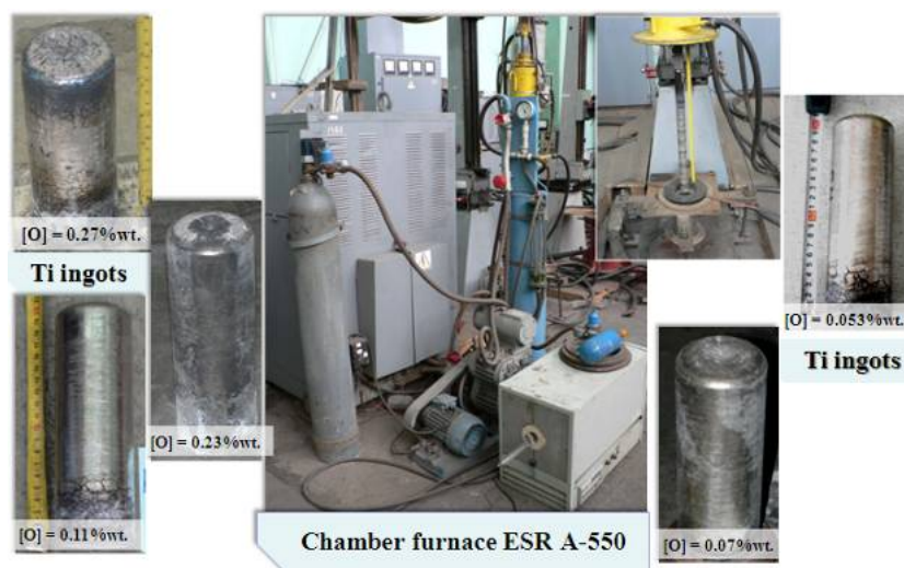
Fig. 3 – Alloying titanium by oxygen from gas phases Slika 3 – Legiranje titanijuma pomoću kiseonika iz gasnih faza
