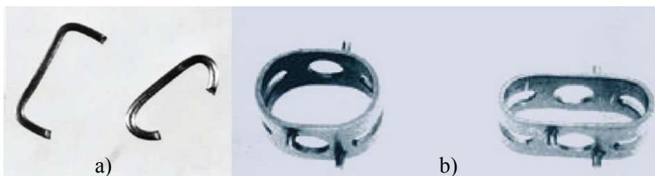
Slika 6 – a) SMA spojnice pre i nakon deformisanja, b) SMA odbojnik pršljenova pre i nakon deformisanja
