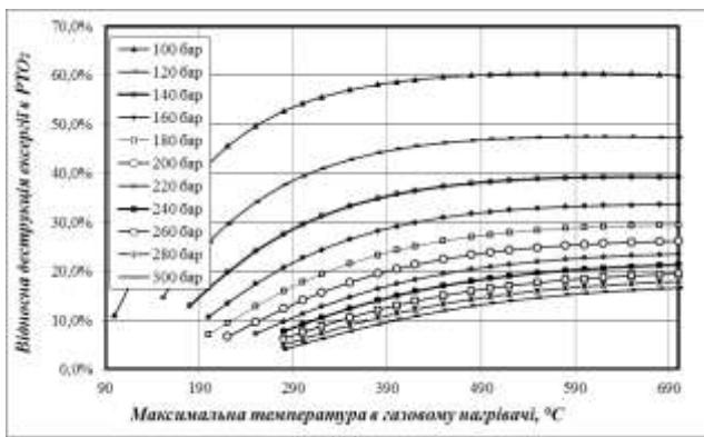
**Рисунок 4.17 – Залежність відносної деструкції ексергії в PTO<sub>2</sub> (Y<sub>дестр</sub>) від тиску (p<sub>ен</sub>) та максимальної температури (t<sub>ен</sub>) в газовому нагрівачі.**
