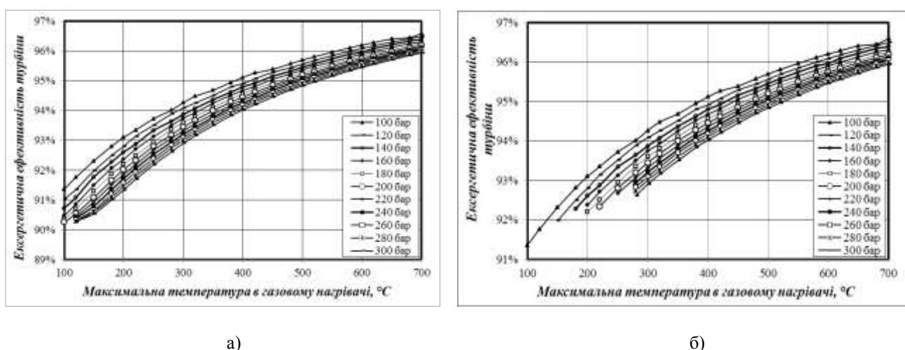
**Рисунок 4.9 – Залежність ексергетичної ефективності турбіни ( $h_{em}$ ) від тиску ( $p_{en}$ ) та максимальної температури ( $t_{en}$ ) в газовому нагрівачі; а – без регенерації, б – з регенерацією**
