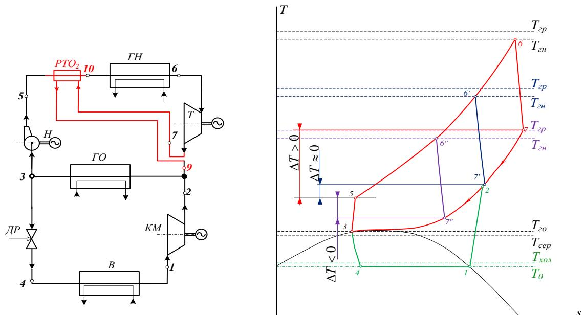
Рисунок 2 – Схема машини та цикл з регенеративним теплообмінником в прямому контурі.
