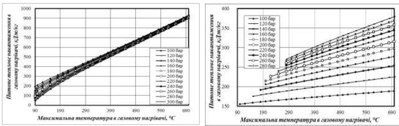
**Рисунок 4.2 – Залежність питомого теплового навантаження на газовий нагрівач ( $q_{ch}$ ) від тиску ( $p_{ch}$ ) та максимальної температури ( $t_{ch}$ ) в ньому; а – без регенерації, б – з регенерацією.**
