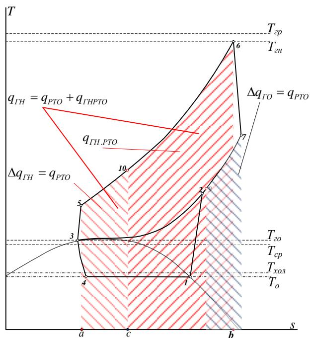
Рисунок 3 – Термодинамічний аналіз прямог циклу за допомогою діаграми T-s
