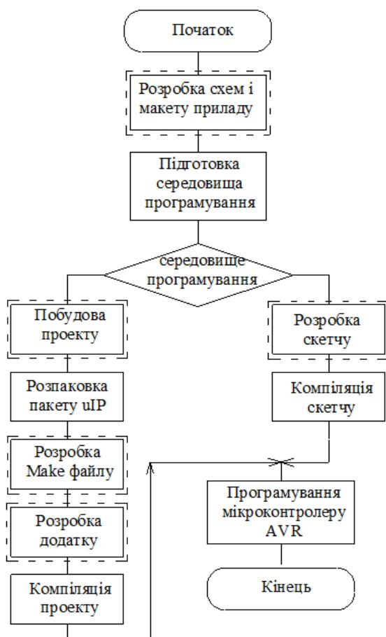
**Рисунок 1 – Алгоритм реалізації приладу для використання в локальній комп'ютерній мережі**
