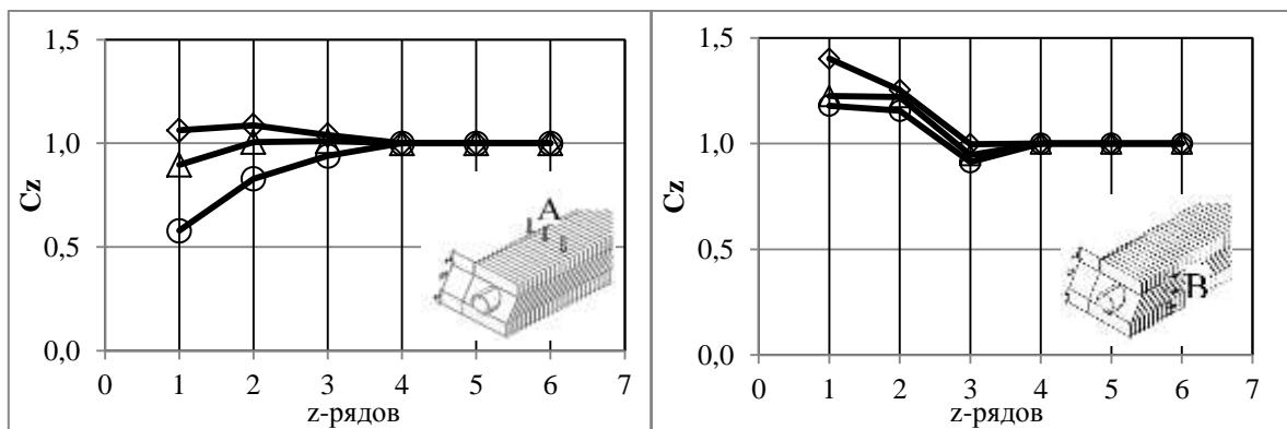
Рисунок 3 – Зависимость  $Cz = f(z)$  для коридорных пакетов труб при разных значениях скорости воздуха:
