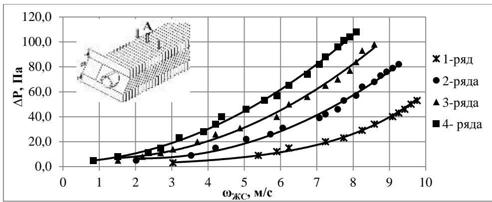
Рисунок 1 – Зависимость  $\Delta P = f(\omega_{JC})$  для однорядных, двухрядных, трехрядных и четырехрядных коридорных пакетов труб (вариант обтекания A)
