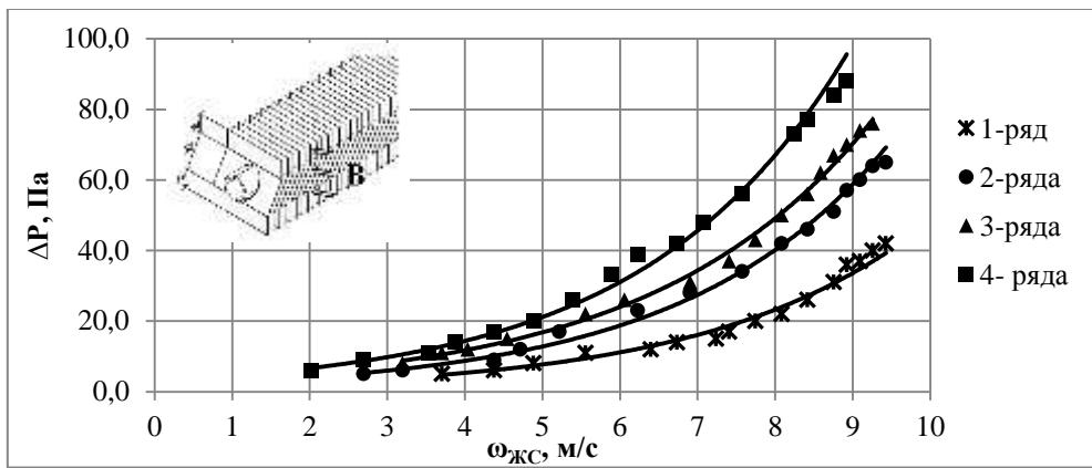
Рисунок 2 – Зависимость  $\Delta P = f(\omega_{JC})$  для однорядных, двухрядных, трехрядных и четырехрядных коридорных пакетов труб (вариант обтекания B)
