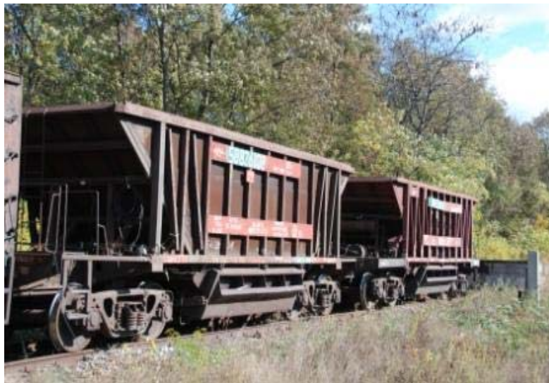
Рис. 4. Расположение вагонов при ударных испытаниях
