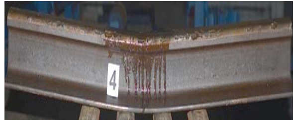
Рис. 8. Деформований зразок рейки № 4
