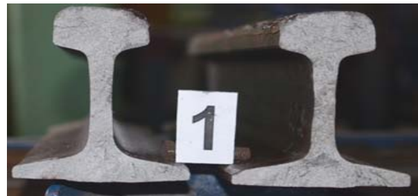
Рис. 5. Вигляд зламу дослідного зразка рейки № 1
