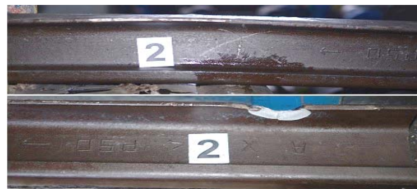
Рис. 6. Деформований зразок рейки № 2
