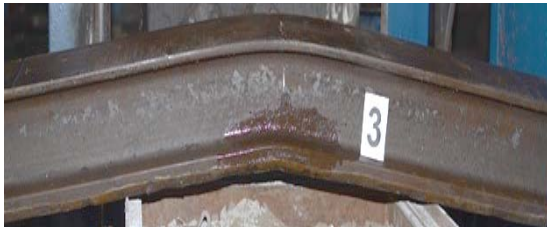
Рис. 7. Деформований зразок рейки № 3
