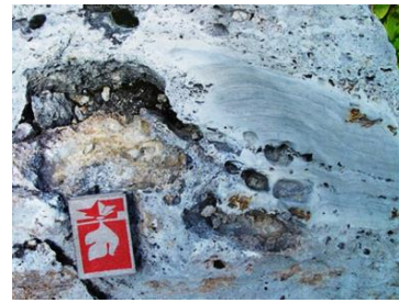
Рис. 11. Фрагмент тонкослоистого мергеля в ДБИ и характер распределения каверн (карьер, д. У.-Бугальши)
