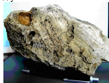
Рис. 12. Тонкослоистый глинистый известняк при поступлении воды и газов резко увеличил пористость и испытал локальные деформации; отчетливо видны изгибы слоев и микросдвиги около крупных газовых пузырей (участок Верхний Бияваш, юго-западный склон плато)
