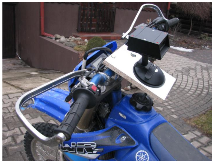
Rys. 3. Sposób zamontowania przyrządu pomiarowego Fig. 3. Way of mounting the measuring instrument
