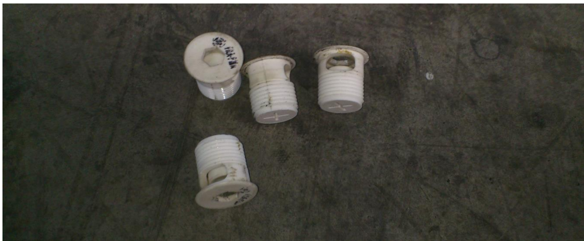
Rys. 10. Hermetyczne drenaże sprężynowe dolnej części kadłuba
