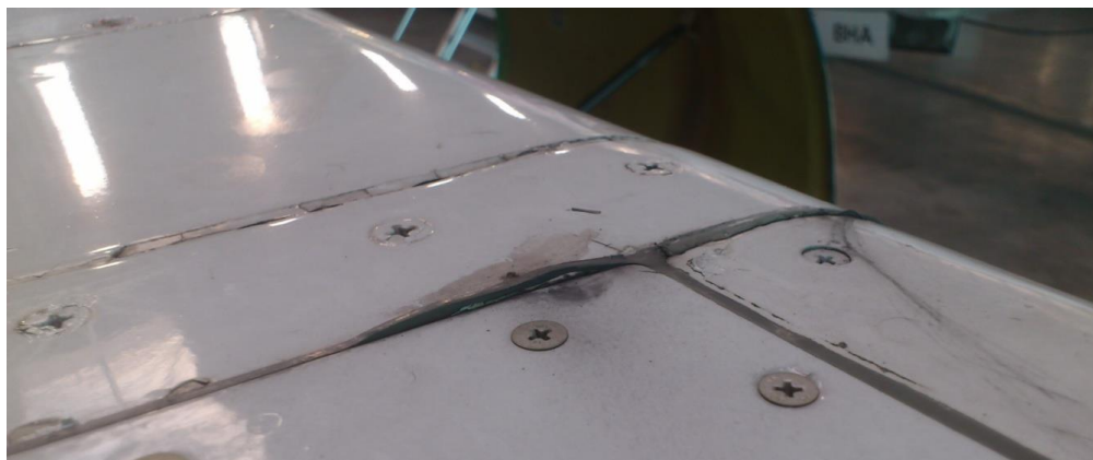
Rys. 15. Uszkodzenie uszczelnienia między górnymi panelami dostępowymi pylonu samolotu Boeing 737-400 spowodowane niewłaściwym wykonaniem samego uszczelnienia
