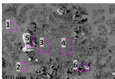
Рис. 9 – Микроструктура и химический состав исследуемых участков слитка, полученного из проволоки с наполнителем B_4C + ZrO_2 (РЭМ режим BEI)
