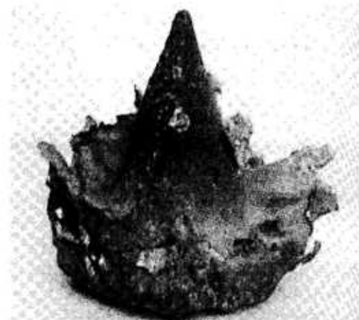
Sl. 8 – Realan izgled preoblikovanog diska („projektila“)
