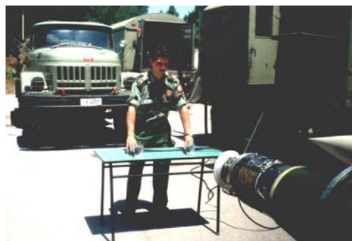
Sl. 5 – Postavljanje levak-antena imitatora cilja i ometača ispred antene rakete 3M9M3 – pogled sa leve strane
