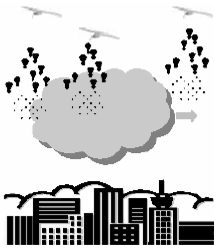
Sl. 5 – Praćenje akcidentnog gasnog oblaka distribuiranom senzorskom ad hoc mrežom
