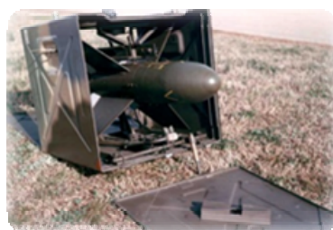
Slika 3 – Entac projektil u lanseru (metalna kutija)
