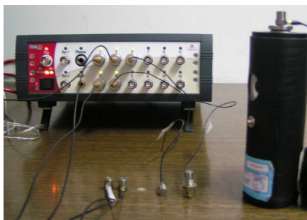
Slika 6 – Izgled akvizicionog sistema NetdB12 sa akcelerometrima Figure 6 – NetdB12 acquisition system with accelerometers
