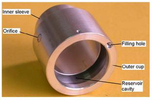
Fig. 4. Centrifugal lubricator.
