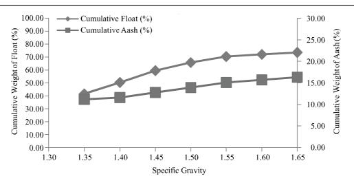
FIG. 5(a).WASHABILITY CURVES FOR SIZE FRACTION -3.35 + 1.4mm SHOWING CHANGE IN ASH CONTENT
