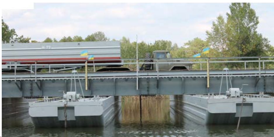
Рис. 5. Проїзд одиночних автомобілів під час натурних випробувань
