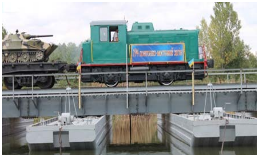
Рис. 1. Проїзд залізничного рухомого складу (тяговий тепловоз ТУ-2 та п'ять платформ із військовою технікою)
