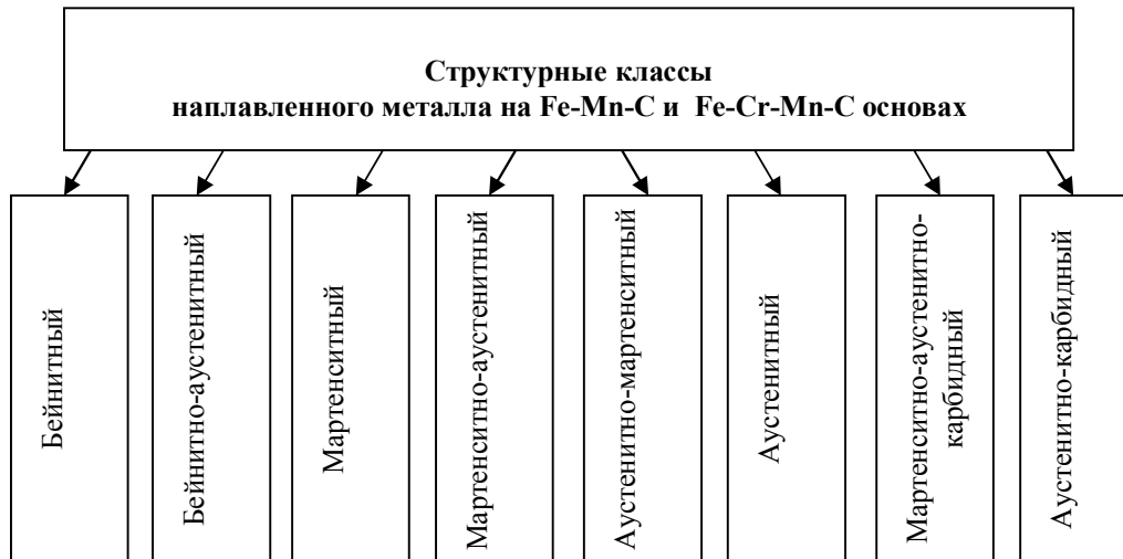
Рис. 1 - Структурные классы наплавленного металла, получаемого при использовании новых наплавочных материалов
