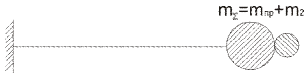
Рис. 2 – Расчетная схема динамической модели
