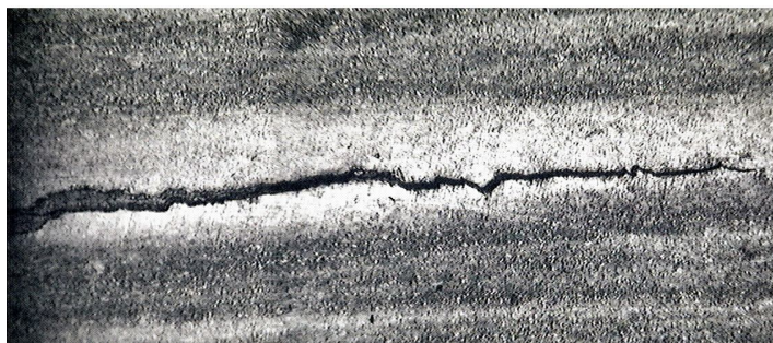
Рис. 1 – Трещина термической усталости в стали 50ХН, расположенная в ликвационной полосе фосфора ( \times 100 , травление реактивом Обергоффера)
