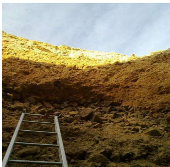
شکل 6. ناهمگنی اندازه ذرات مواد باطله در ترانشه F
