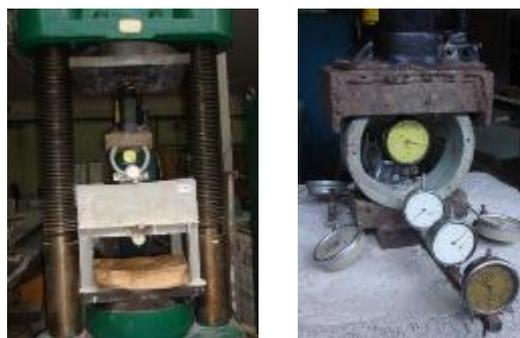
**Рис. 2. Общий вид исследовательского оборудования: а) испытательный стенд; б) размещение приборов в верхней зоне (на примере плиты марки П-30)**
