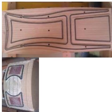
Фиг. 3. Вакуум поставки (калъпи) за осигуряване стабилно захващане на заготовките
