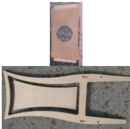
Фиг. 1. Облегалка и „моноблок”, изработени на 5-осен ДОЦ
