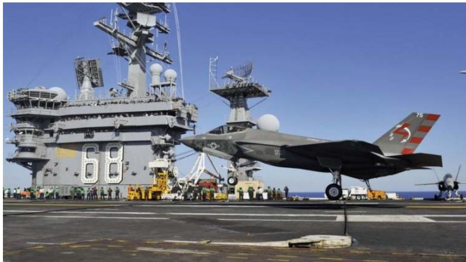
Početkom novembra 2014. godine palubni višenamenski borbeni avion F-35C lajtnening II (*Lockheed Martin F-35C Lightning II*) izvršio je prvo sletanje na nosač aviona „Nimic“ (*USS Nimitz – CVN 68*) uz primenu kuke i sajle za zaustavljanje (tzv. *arrested landing*). Planirano je da ispitivanja na nosaču „Nimic“ traju dve sedmice.
