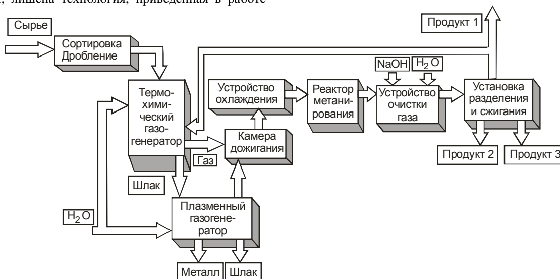
Рисунок 1 – Схема установки утилизации опасных отходов
