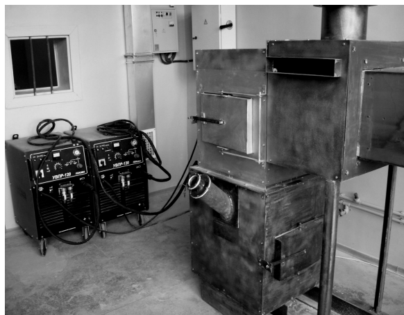
Рисунок 3 – Печь для утилизации полимерных композиционных материалов
