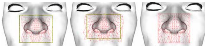
Figura 4. eTrace – exemplificarea algoritmului de determinare a suprafeței selectate: a) numai poligoanele complet incluse în zona selectată; b) poligoanele parțial incluse în zona selectată; c) noua reprezentare poligonală pentru zona selectată.
