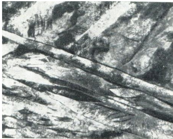
Рис. 2 – Структура сталі після гартування, x18000
