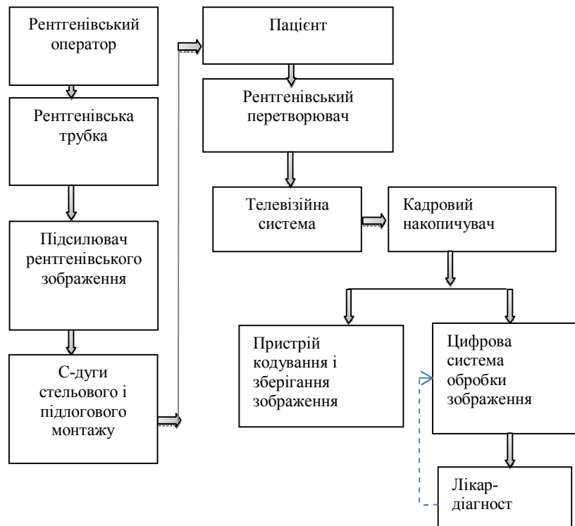
Рис. 1. Функціональна схема автоматизованої обробки ангиографічних зображень
