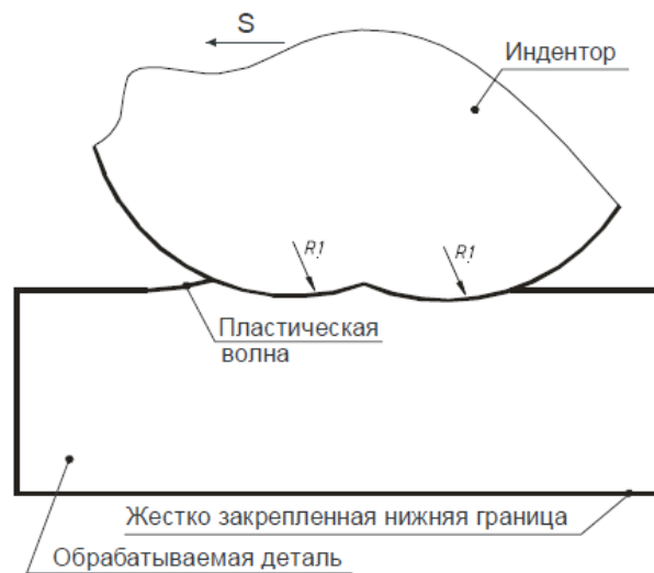
Рисунок 1 - Постановка задачи конечно-элементного моделирования обработки роликом специального профиля третьего типа [5].
