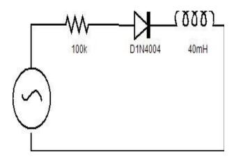
Fig. 1. Simple non linear RLC circuit.
