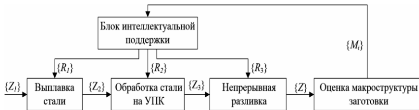
Рис. 2. Схема многостадийного производства непрерывно-литой заготовки
