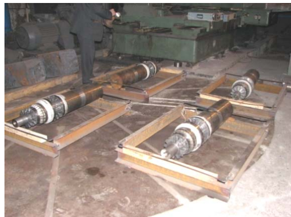
Рис. 1. Загальний вид на півосей, з яких виготовлялися зразки для проведення випробувань на втому
