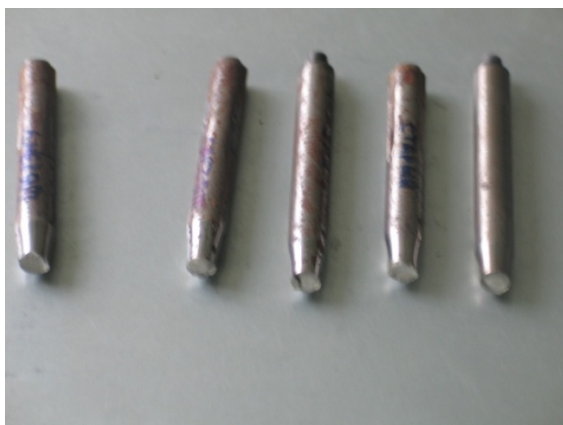
Рис. 9. Види перерізів зразків в місцях їх руйнування
