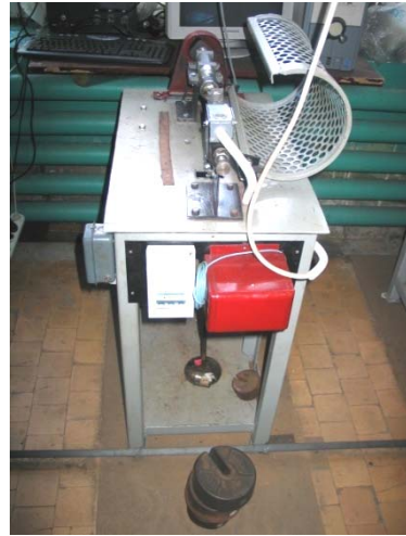
Рис. 6. Загальний вигляд стенда для проведення випробувань зразків на втому
