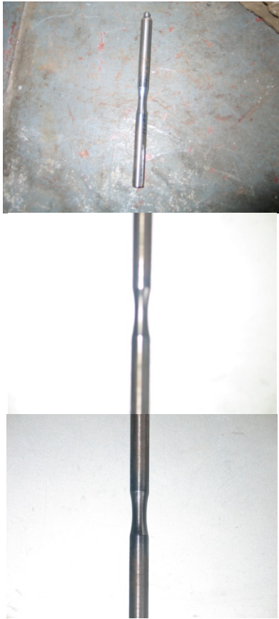
Рис. 3–5. Загальні види зразків для проведення випробувань на втому
