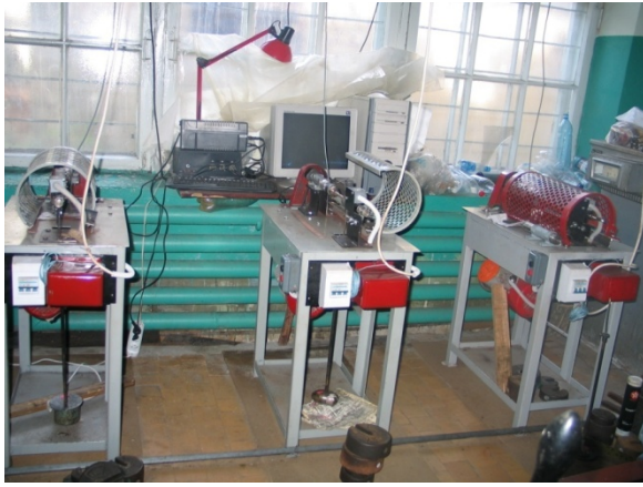
Рис. 8. Загальний вигляд випробувальної станції для проведення випробувань матеріалів на втоми
