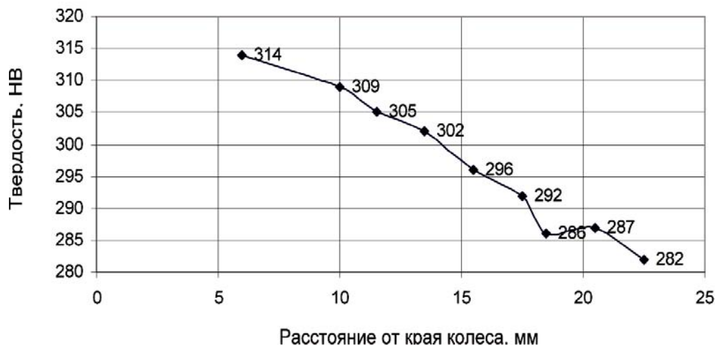
Рис. 9. Розподіл твердості на боковій поверхні колеса А
