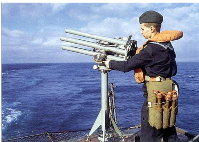
Рис. 3. Противодиверсионный многоствольный реактивный гранатомет МРГ-1
