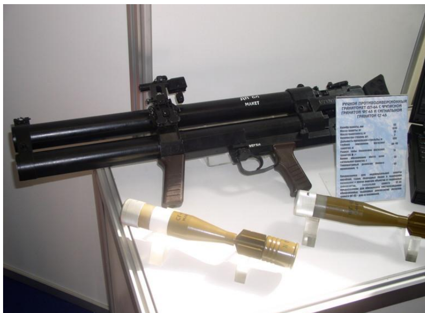
Рис. 5. Ручной противодиверсионный гранатомет ДП-64 и его гранаты
