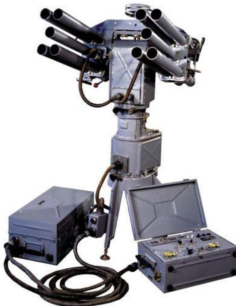
Рис. 4. Противодиверсионный автоматизированный гранатометный комплекс ДП-65
