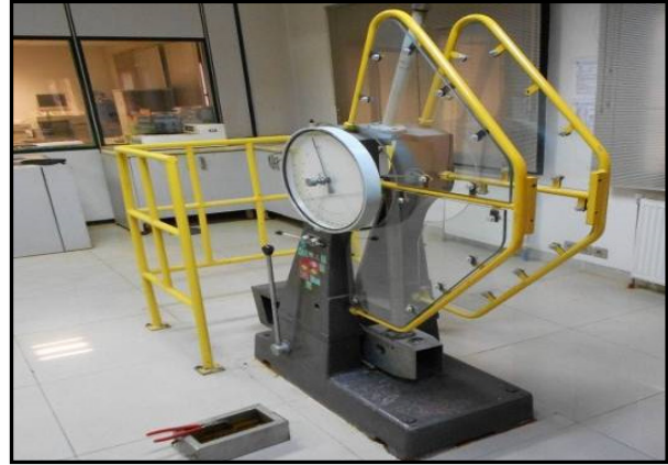
Şekil 2. Çentik darbe numune örneği ve cihazın görüntüsü
