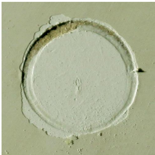
Фото 6. Отрыв EXEDRA SPATOLA от Т03. Толщина первого оторванного слоя 50 мкм, адгезия 0,1 МПА
