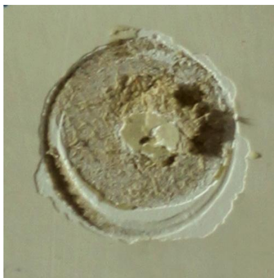
Фото 8. Отрыв EXEDRA SPATOLA от Т03. Толщина второго оторванного слоя 210 мкм, адгезия 2,0 МПА
