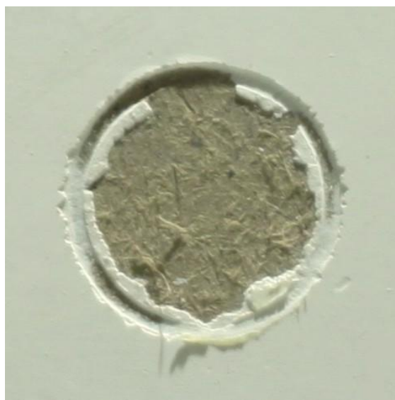
Фото 11. Отрыв ORIGINI с DECOR FONDO RIVEDIL от MDF. Адгезия 0,9 МПА
