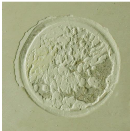
Фото 7. Отрыв EXEDRA SPATOLA от Т03. Адгезия 1,0 МПА
