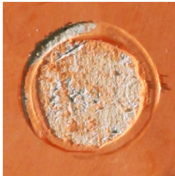
Фото 13. Отрыв VENEXIAN от FARINA DI QUARZO. Толщина оторванного слоя 200 мкм. Адгезия 1,6 МПа
