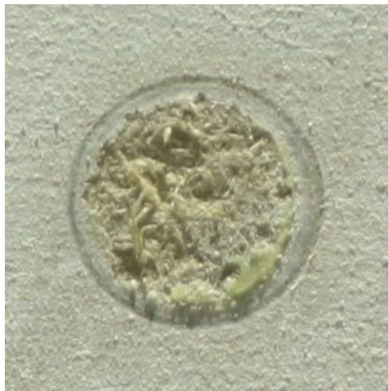
Фото 2. Отрыв грунтовочного покрытия FARINA DI QUARZO от MDF. Адгезия 1,7 МПА
