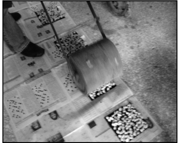
Şekil 7. Mekanik sericiye yerleştirilmiş ve silindireme esnasındaki numuneler.
