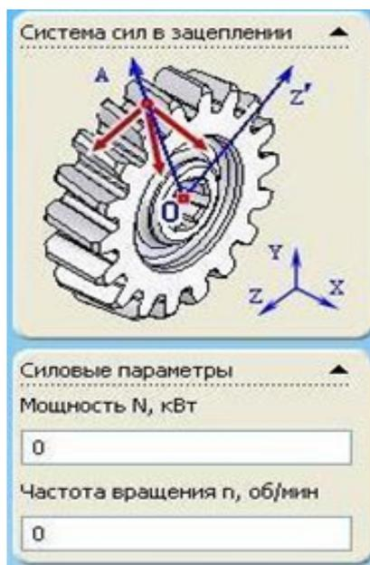
Рис. 3. Фрагмент панели для задания динамических и кинематических параметров передачи
